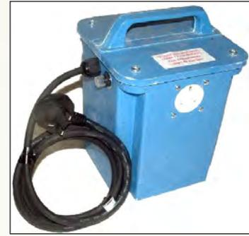
隔離變壓器的插座的地線（水線 earth/ground）插孔，不應與隔離變壓器的金屬外殼或者電源的地線連接。這是要防止電源的地線插孔的故障電壓傳導到用電器具。例如某家居固定電力裝置的 MCB 箱的空調機電路有電器對地漏電，但空調機電路未裝設 RCD，而接地電阻甚大（例如  $15\Omega$ ，因使用 TT 接地系統），故障未能由 MCB 的過流跳脫功能來清除。這時故障電壓便可透過接地系統來傳導到其他用電器具的外殼。即使插座使用 RCD 保護，RCD 也不能清除此故障。隔離變壓器能解決這個漏洞。在香港，有些廠商製作隔離變壓器，但他們未必明白此原理。訂購隔離變壓器的時候，請特別留意。讀者也可在某英國電子元件供應商網站訂購在英國生產的隔離變壓器。隔離變壓器要符合 BS EN 61558 的要求。合格的隔離變壓器絕少發生失效的問題，反而 RCD 不時會失效。
