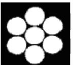
單拉力強度鋼纜 (Single Tensile Rope)：內外層鋼絲具有相同的拉力強度例如外和內層的鋼絲全部都是 1570 N/mm<sup>2</sup>
