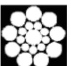
雙拉力強度鋼纜 (Dual Tensile Rope)：內外層鋼絲具有不相同的拉力強度。例如內和外層的鋼絲拉力是 1370 N/mm<sup>2</sup> 和 1770 N/mm<sup>2</sup>
