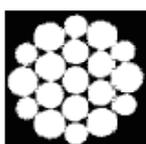
例：Warlington type 的每股鋼纜的構造。最外第一層粗幼相隔，提供較好柔軟度和拉力強度，但較低磨損和擠壓的阻力。
