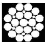
例：Filler type 的每股鋼纜的構造。第二層的幼鋼絲填補大鋼絲之間的空隙，提供較好的擠壓阻力，有好的柔軟度、拉力強度和磨損阻力。
